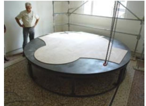
Indépendamment des inconvénients constatés — cliquetis des billes, petites secousses, patinage de la roue motrice due à la déformation du plateau — le fonctionnement actuel du mécanisme pourrait être encore affecté par l'écrasement progressif des billes porteuses qui immobiliseraient à terme le plateau ; ceci ne saurait être évité qu'en procédant à la rotation très régulière du plateau.
